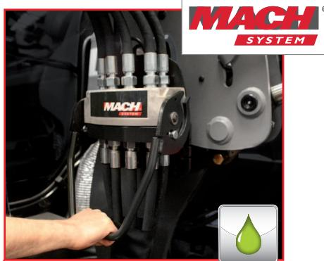
MACH System® bezúkapová sdružená rychlospojka. Jedním pohybem propojí všechny hydraulické i elektrické funkce
