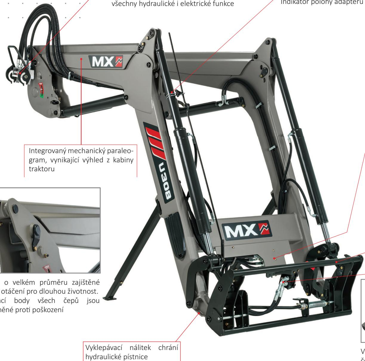
Čepy o velkém průměru zajištěné proti otáčení pro dlouhou životnost. Mazací body všech čepů jsou chráněny proti poškození
