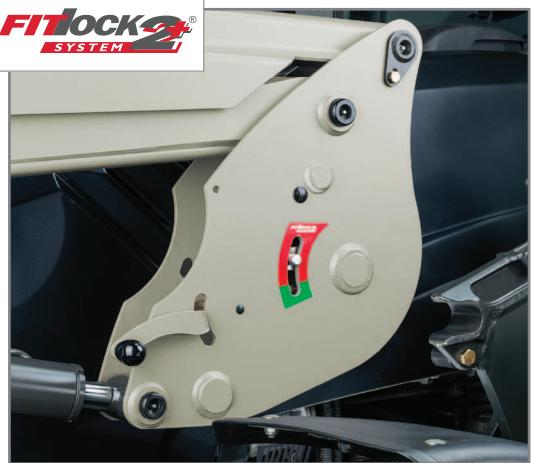
FITLOCK System® – je plně automatický způsob uchycení, který umožňuje připojit a odpojit nakladač pouze při jednom opuštění kabiny traktoru
